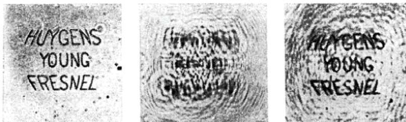
Рис. 3. Пример результатов исследований Габора (исходный объект, синтезированная на его основании голограмма и восстановленное изображение)
