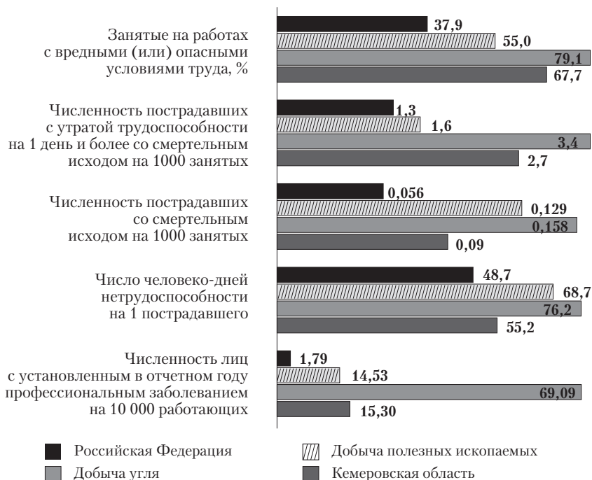
Рис. 1. Состояние условий труда, производственного травматизма и профессиональной заболеваемости на предприятиях по добыче угля в 2017 г. (по данным Росстата)
